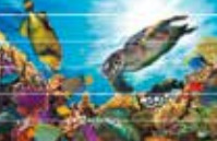
Écart / Traces blanches (Alimentation papier excessive)
