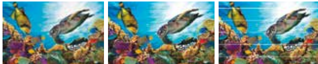
Position incorrecte de dépôt bidirectionnel des gouttelettes
